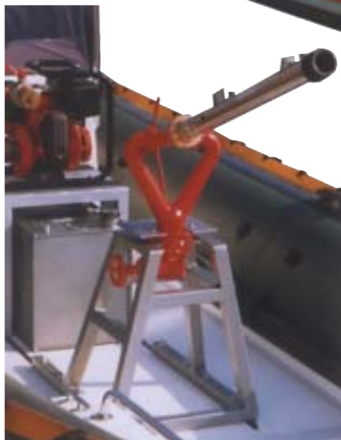
En Asso-båt utrustad med vattenspruta för brandbekämpning.
