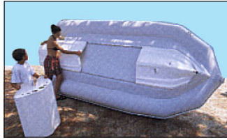
Här monteras de tre skrovsektionerna.
